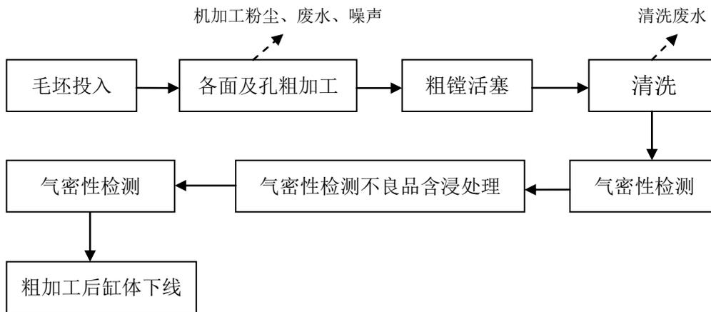
图 4.4 项目粗加工工段主要流程
