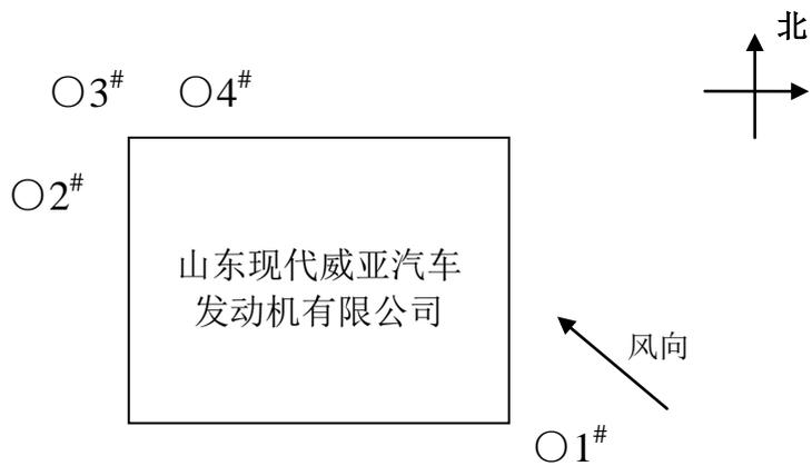
图 9.3 2017.6.13 无组织废气监测点位示意图
