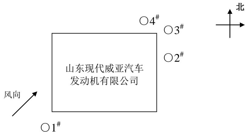
图 9.4 2017.6.14 无组织废气监测点位示意图
