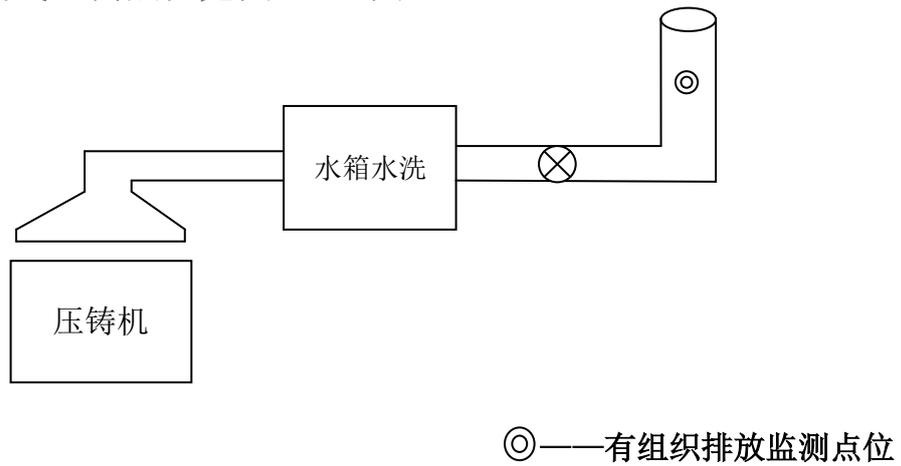
图 9.1 浇注工艺有组织排放监测点位示意图
