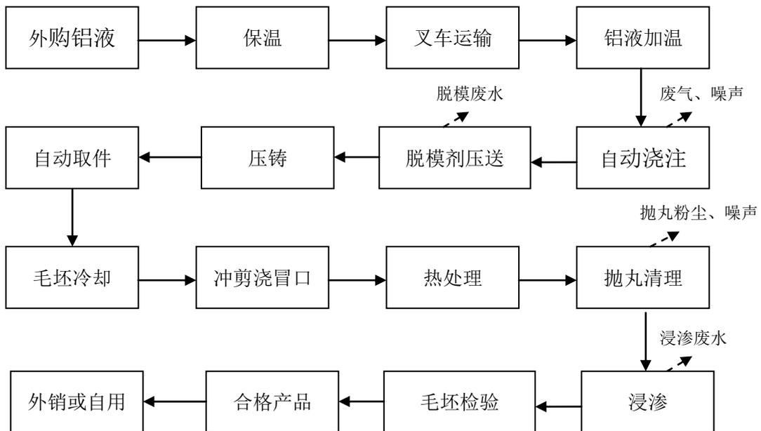
图 4.3 项目压铸工艺主要流程
