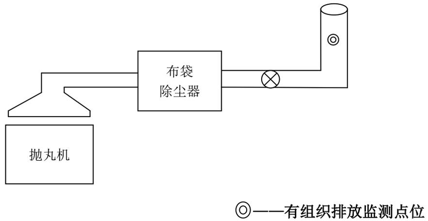
图 9.2 抛丸工艺有组织排放监测点位示意图
