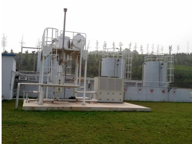
图 5.1 油气回收装置
